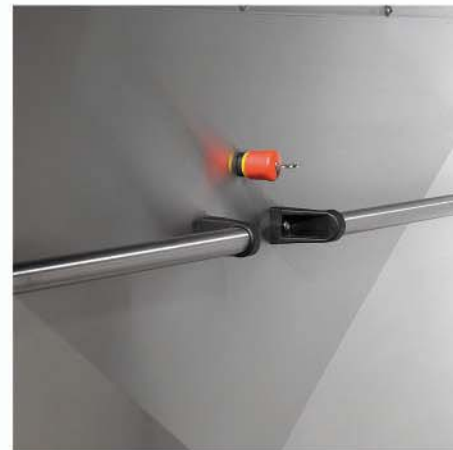
Ein abschließbarer Not-Aus Knopf verhindert unbefugte Benutzung
